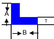
เหล็กฉาก MILD STEEL ANGLE BAR
